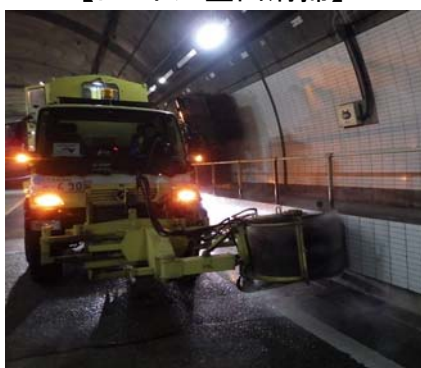
【トンネル火災に備えた水噴霧放水試験】
